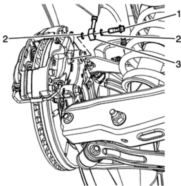
1. Déposer le boulon (1) du raccord de flexible.
