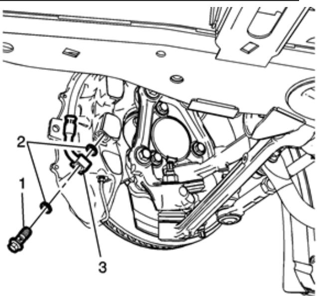
1. Assembler le boulon (1) de raccord de flexible de frein avec 2 nouveaux joints (2) de raccord de flexible de frein sur le flexible de frein (3).
