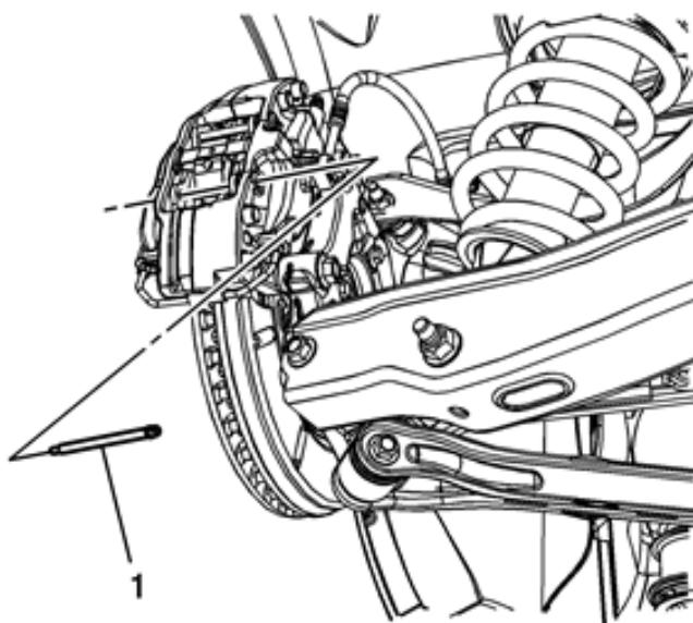
7. Maintenir en place l'extrémité du ressort de plaquette de frein et enfoncez soigneusement l'axe (1) de plaquette de frein inférieur dans l'étrier de frein.
