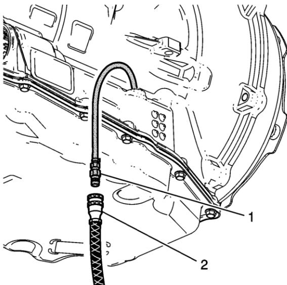
**Remarque :** l'outil de rinçage et de test de débit DT-45096 est utilisé comme méthode pratique pour pomper le liquide dans le carter inférieur. Une pompe à main adaptée peut également être utilisée à la place. Lors de l'utilisation de l'outil de rinçage et de test de débit DT-45096, surveiller le panneau d'affichage pour déterminer la quantité de liquide qui est pompée du réservoir d'alimentation de l'outil vers la boîte de vitesses.
