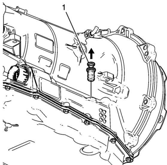
**Nota:** Puede ser necesario usar un par de pinzas de punta de aguja de 90 grados largas para levantar el émbolo y retirar el ensamble del tapón.
