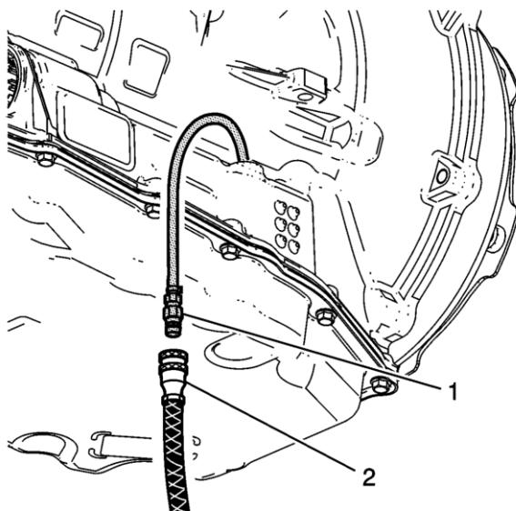
**Nota:** La herramienta de prueba de lavado y flujo DT-45096 se utiliza como un método conveniente para bombeo del fluido al cárter inferior. También se puede usar una bomba manual adecuada en su lugar. Cuando use la herramienta de prueba de lavado y flujo DT-45096, monitoree el tablero de la pantalla para determinar la cantidad de fluido que se bombea del tanque de suministro de la herramienta a la transmisión.
