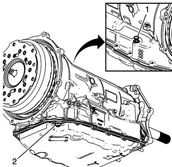
**Precaución:** Use fluido de transmisión Dexron® HP únicamente. La falla en usar el fluido adecuado puede resultar en daño interno a la transmisión.
