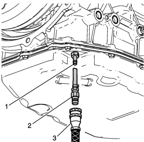
2. Poser l'adaptateur de carter de remplissage de liquide DT-51190 (1) et, si nécessaire un des adaptateurs de rinçage de refroidisseur DT 45096-30 (2).
