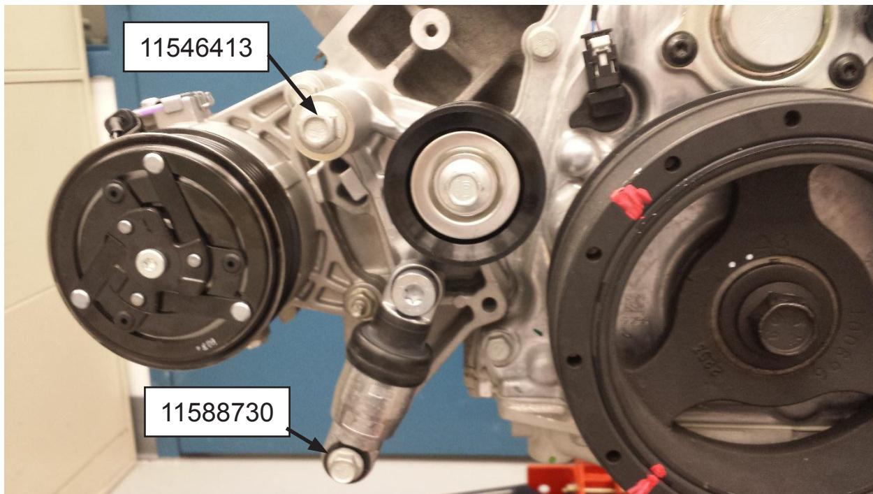
4. Poser l'alternateur avec deux (2) boulons 11546413. Serrer l'écrou à 54 Nm (43 lb pi).
