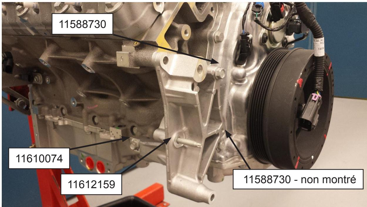
2. Poser le compresseur de climatiseur 23105946 avec 11588694. Serrer à 22 Nm (16 lb pi). Poser l'écrou 11610074 sur le goujon. Serrer l'écrou à 22 Nm (16 lb pi).
